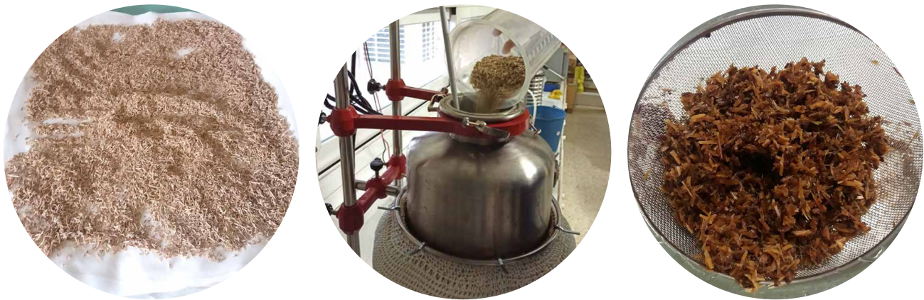
FIGURA 3. Fibra de madera triturada y tamizada procedente de residuos de OTP (izquierda), configuración del tratamiento químico de la fibra a escala de laboratorio (centro) y fibra de OTP tratada químicamente (derecha).
